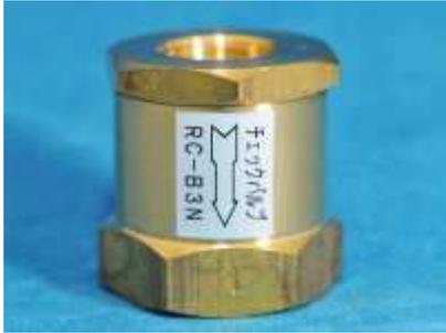
RC型チェックバルブはスプリングを使用せず“O”リング弾性を利用して一方のみ流れ、逆方向には絶対漏らさない、ロボット、エア－ハイドロに最適。
