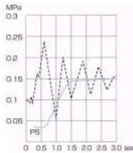
ダンプナーは配管途上の脈動を完全に防止し、圧力計・圧力スイッチ等の破損を防ぎ、ゲージの読み取りをたやすくする防振装置です。
