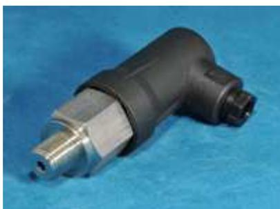
本器は流体の圧力が設定された圧力の値に達したとき、マイクロスイッチを作動させ、電気接点を開閉して電気信号を出す。
