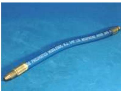
本器は工作機械等のクーラント用にもちいられるもので、ネオプレン製のチューブの芯に銅製の棒を挿入し、屈曲自在で安定した位置を確保することができる。
