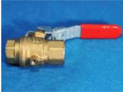
BVC型ボールバルブは特にコンプレッサーの元コック用として開発されたもので、バルブを閉じた時2次側の残圧を瞬時にゼロにするようバルブ底に放出穴を設けている。
