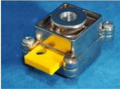
V型ロックアウトバルブは平プレートをスライドさせることにより、2方口はシャットオフ作動でメンテナンス及びバイパス回路に役立ち、3方口の場合は一次圧をストップさせ2次圧を大気放出させる。どちらも閉の状態で南京錠がかけられる。
