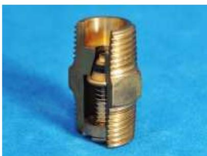
本器は一方のみ流れ、逆方向には絶対洩らさない。インライン型高圧チェックバルブで、特にポペット部は“O”リングのため、敏感な逆止効果でダブルタッチのため高圧に耐えることができる。
